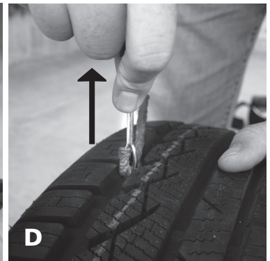
D Tirare con forza il punteruolo sino ad estrarlo dal foro. In questa operazione la striscia di gomma deve sfilarsi dal punteruolo e rimanere all'interno del foro da riparare.
