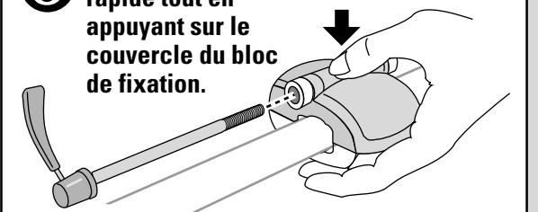
Poser l'écrou de l'axe à serrage rapide.
