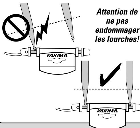
**14** Ouvrir le levier et serrer l'écrou jusqu'à ce que le levier se ferme avec une bonne résistance.
