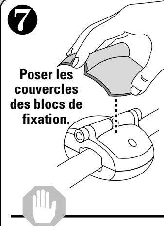
**Les couvercles des blocs de fixation doivent obligatoirement être en place pour assurer la sécurité du porte-vélos.**
