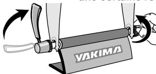
Serrer ou desserrer l'écrou au besoin de manière que le levier se ferme avec une certaine résistance.
